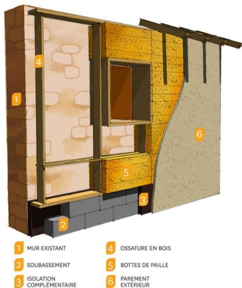
Figure 10 : Schéma de principe d'une ITE Paille
