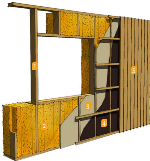
Figure 4 : Paille en remplissage d'une ossature bois, technique prédominante chez les entreprises artisanales et les auto-constructeurs. La première maison construite selon cette technique date de 1920 (Maison Feuillette)
